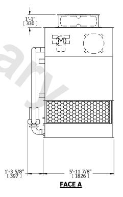
**SHIPPING OPERATING** HEAVIEST SECTION 3570 lbs+ [1620] kg+ 4810 lbs+ [2185] kg+ WEIGHT WEIGHT WEIGHT
