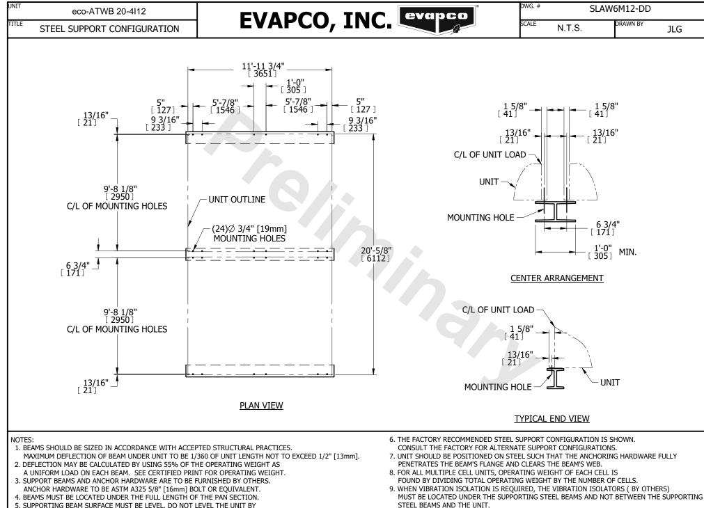
SUPPORTING BEAM SURFACE MUST BE LEVEL. DO NOT LEVEL THE UNIT BY PLACING SHIMS BETWEEN THE UNIT MOUNTING FLANGE AND THE SUPPORTING BEAM.
