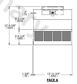
**SHIPPING** OPERATING HEAVIEST SECTION 12460 lbs+ [5655] kg+ 21480 lbs+ [9745] kg+ WEIGHT WEIGHT WEIGHT
