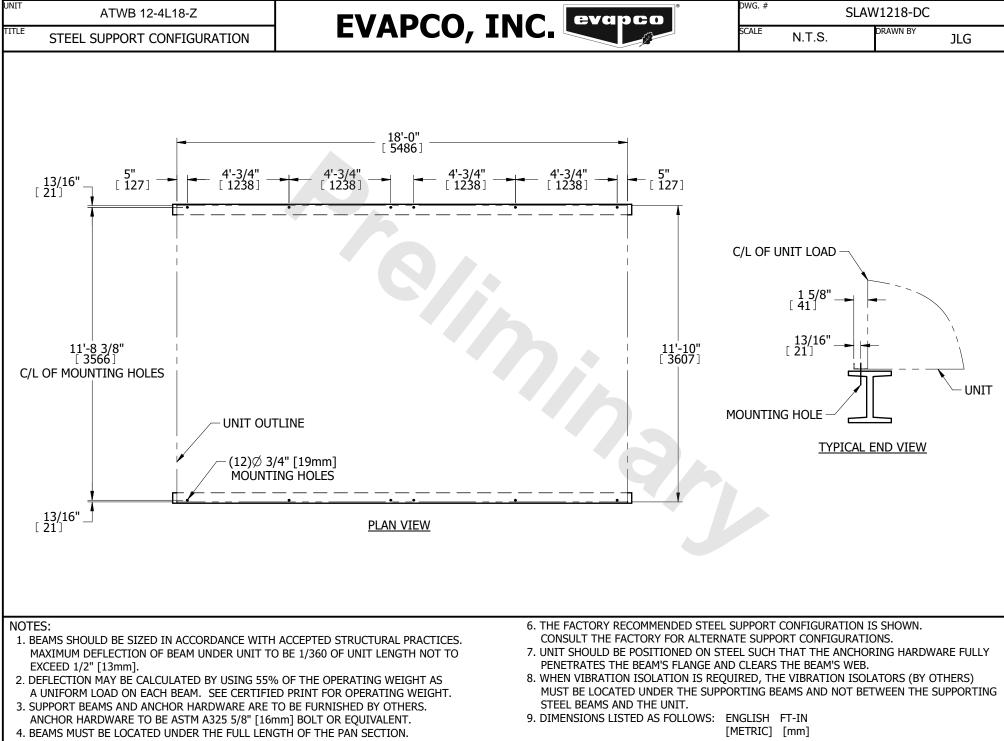
SUPPORTING BEAM SURFACE MUST BE LEVEL. DO NOT LEVEL THE UNIT BY PLACING SHIMS BETWEEN THE UNIT MOUNTING FLANGE AND THE SUPPORTING BEAM.
