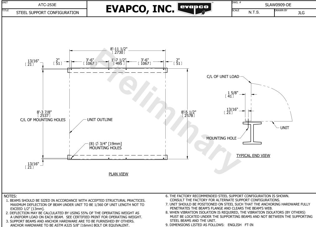
4. BEAMS MUST BE LOCATED UNDER THE FULL LENGTH OF THE PAN SECTION. 5. SUPPORTING BEAM SURFACE MUST BE LEVEL. DO NOT LEVEL THE UNIT BY
