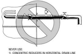
2) VALVES IN HORIZONTAL DRAIN LINE
